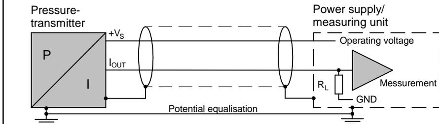
Betriebsspannung / supply voltage / tension d'alimentation..... $V_S$ : 8...30 VDC
