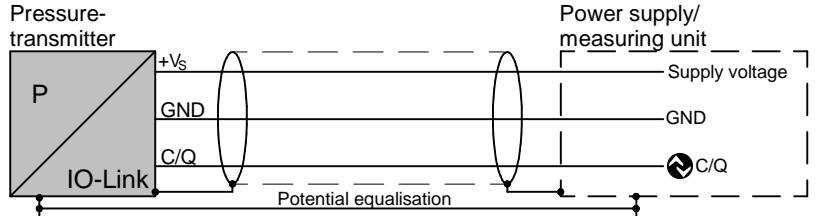
Betriebsspannung / supply voltage / tension d'alimentation.....V<sub>S</sub>\_IO-Link: 18...30 VDC
