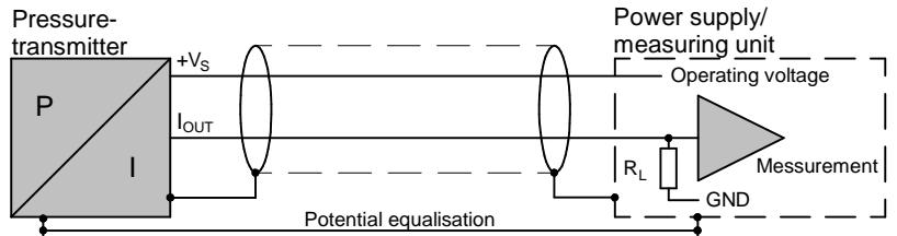
Betriebsspannung / supply voltage / tension d'alimentation.....V<sub>S</sub>: 8...30 VDC (Class 2, UL 1310)
