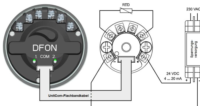
Der FlexTop 22x2 besitzt einen Anschluss für die Direktmontage am DFON-Touch-Display von Baumer. Die Verbindung wird mit einem UnitCom-Flachbandkabel hergestellt. Weitere Informationen erhalten Sie auf Anfrage bei Baumer.
