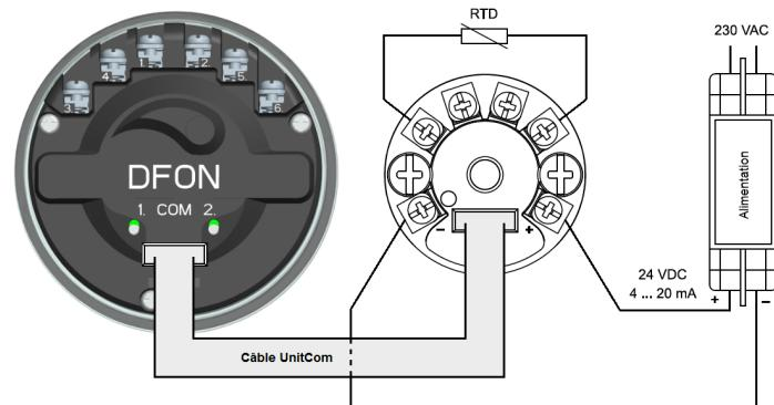
Le FlexTop 22x2 est équipé d'une prise pour le montage direct à l'afficheur tactile DFON de Baumer. La connexion a lieu en utilisant un câble UnitCom. Veuillez contacter Baumer pour plus d'informations.
