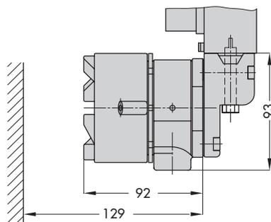
Montaggio secondo NAMUR con tipo 4765 e tipo 3760
