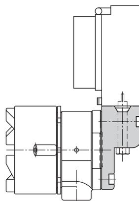
Fig. 5 - Montaggio diretto su posizionatore tipo 3766-000
