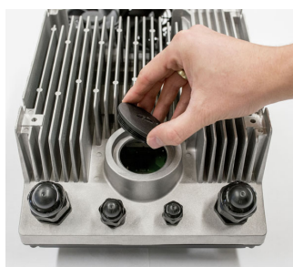
Fig. 27: Rimozione dei tappi filettati
