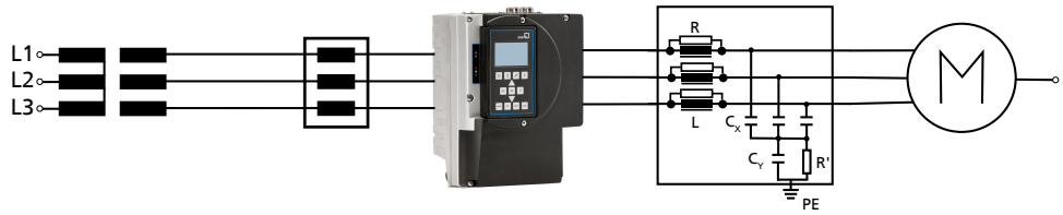
Fig. 31: Montaggio induttore di rete e filtro d'uscita
