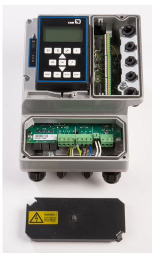
Fig. 14: Rimozione della copertura di protezione
