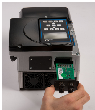
Fig. 42: Inserimento del modulo bus di campo
