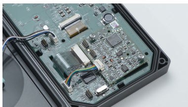
Fig. 50: Fissaggio del modulo Bluetooth
