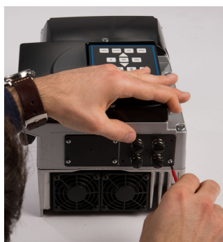
Fig. 43: Fissaggio del modulo M12
