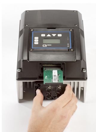
Fig. 29: Inserimento del modulo M12
