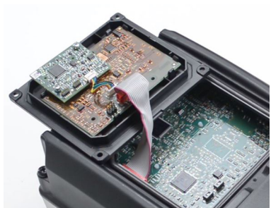
Fig. 40: Montaggio modulo Bluetooth
