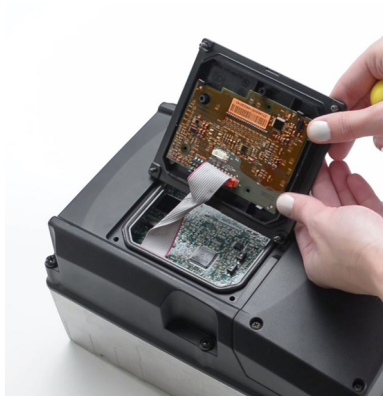
Fig. 39: Apertura del pannello standard di comando
