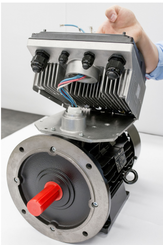
Fig. 24: Inserimento dei cavi motore
