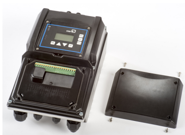
Fig. 10: Copertura del corpo
