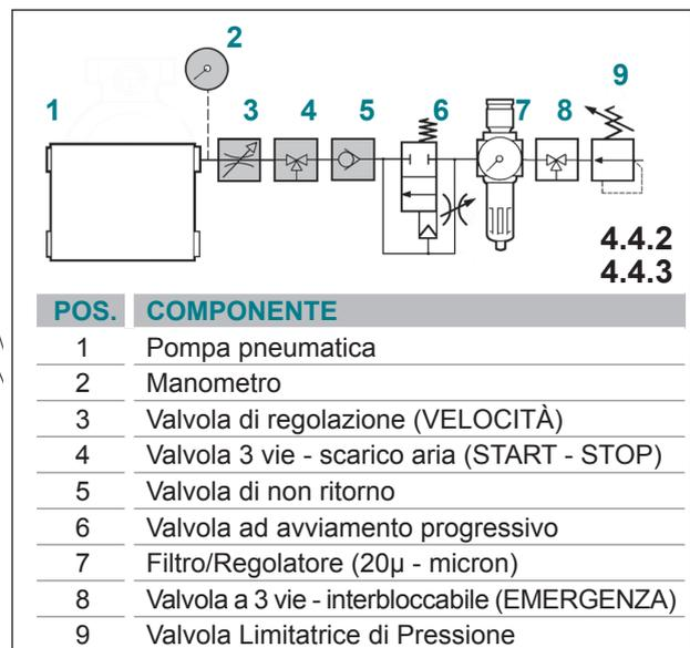
4.4.2 Avvitare sull'attacco del circuito pneumatico della pompa una valvola di regolazione del flusso dell'aria compressa, una valvola a 3 vie (START - STOP con scarico aria) e una valvola di non ritorno, secondo lo schema riportato in figura. Per il controllo della pressione reale dell'aria di alimentazione, bisogna installare un manometro sull'attacco dell'aria compressa della pompa stessa e controllare il valore a pompa in funzione.
