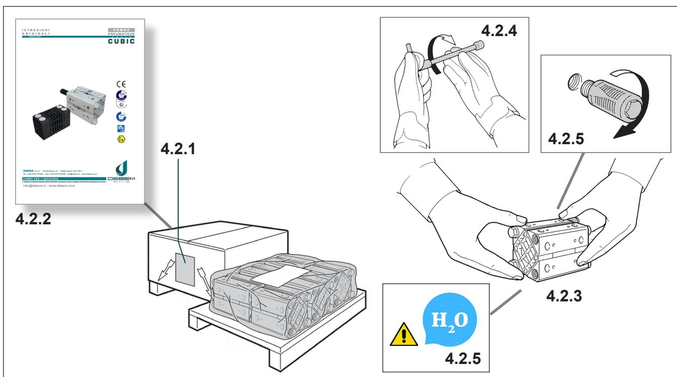
4.2.3 Sollevare la pompa e depositarla su una superficie pulita in ambiente protetto.
