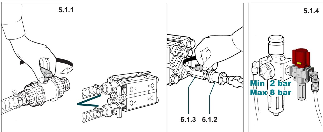
5.1.1 Aprire le valvole di sezionamento del prodotto delle tubazioni di aspirazione e mandata.
