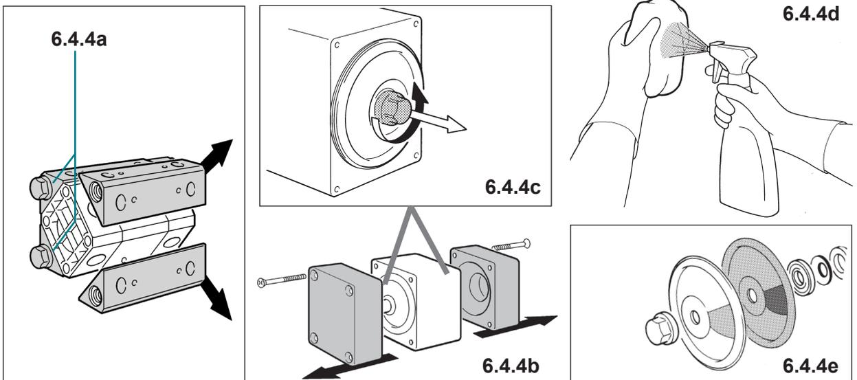
6.4.4a Per le pompe CUBIC 15 eseguire lo smontaggio di tutte le viti di fissaggio e rimuovere i collettori.
