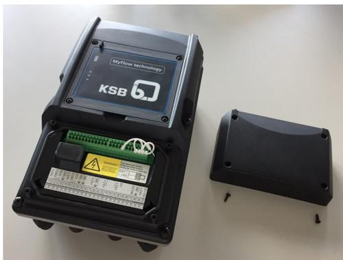
Fig. 10: Copertura del corpo
