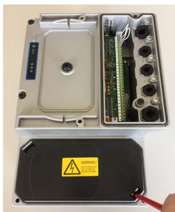
Fig. 14: Sollevamento della copertura di protezione
