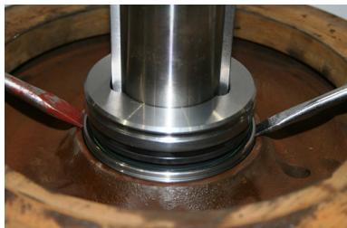
Fig. 16: Estrazione della tenuta meccanica con ferri a leva
