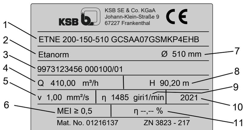
Fig. 5: Targhetta costruttiva (esempio) Etanorm
