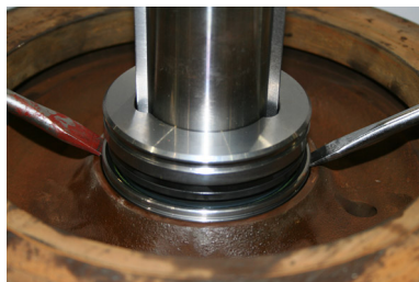
Fig. 10: Estrazione della tenuta meccanica con ferri a leva
