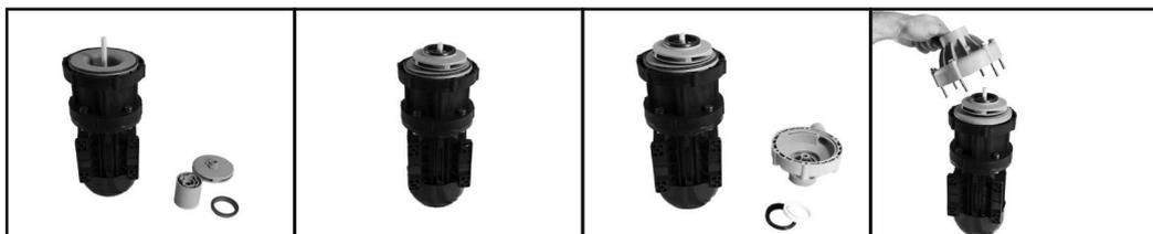
5. Montare il portamagneti interno con girante e ralla.
