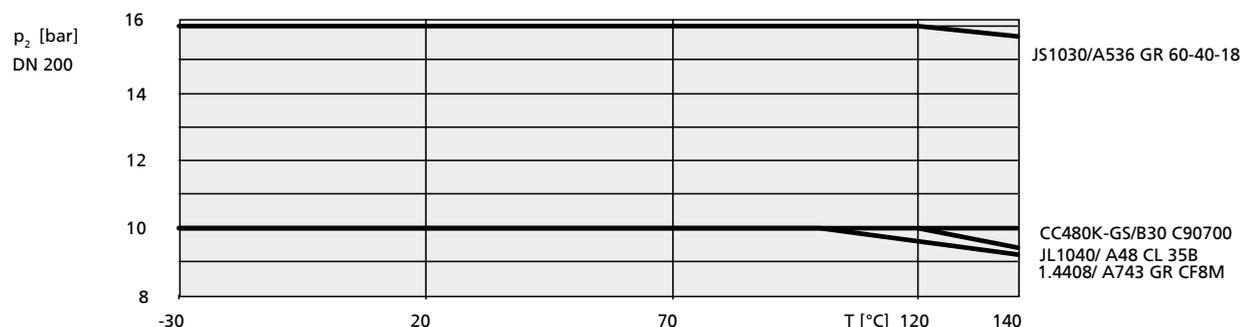
Fig. 2: Limiti di pressione della pompa e limiti di temperatura DN 200
